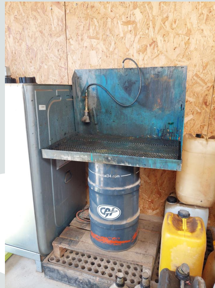
LOT 113 : FONTAINE DE DEGRAISSAGE (pompe amorçage à changer)
